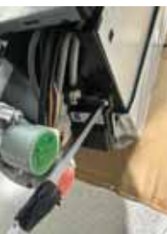
5. Retirez le capteur de fuite.
