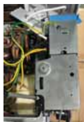
4. Retirez le couvercle de la boîte électrique.
