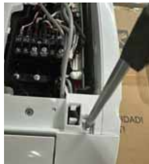
2. Retire el panel del marco derecho.
