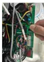
6. Retire la placa del circuito impreso (PCB) y desenchufe el sensor de pérdida de refrigerante del CN3.
